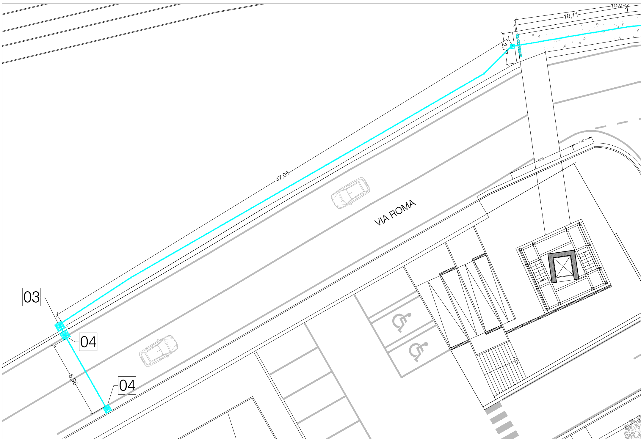
■ Tracciato per collegamento a rete fognaria esistente
